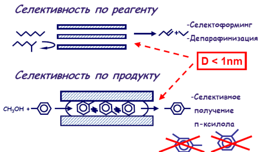
Рис.6 . Молекулярные сита: разделение реагентов и продуктов с разной пространственной структурой. (Из работ профессора И.И. Ивановой).
