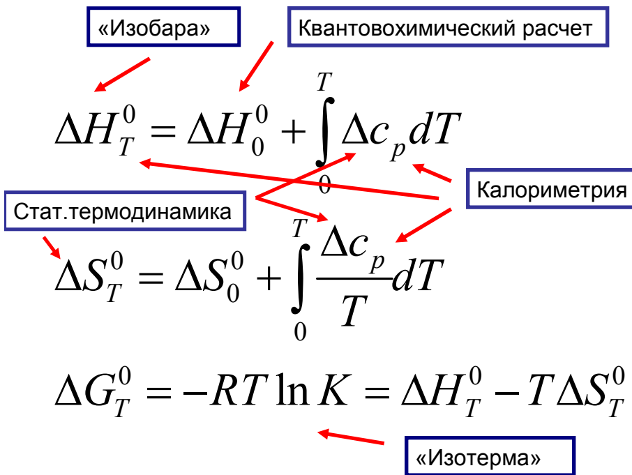
рис. 1. Возможности определения энтальпии и энтропии химической реакции.
